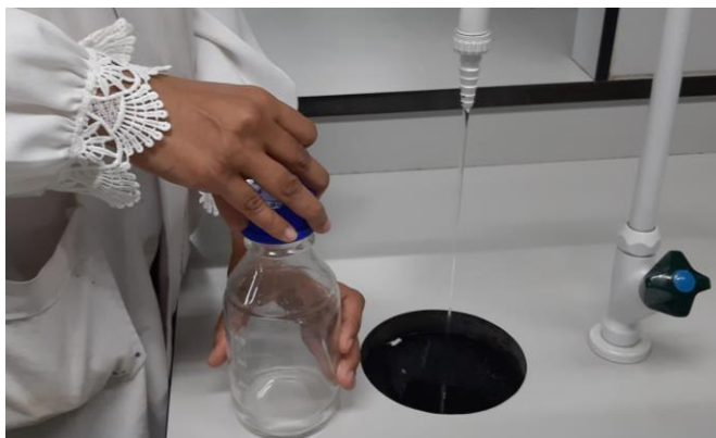
ภาพที่ 22 วิธีการจับฝาขวดเก็บตัวอย่างน้ำ
