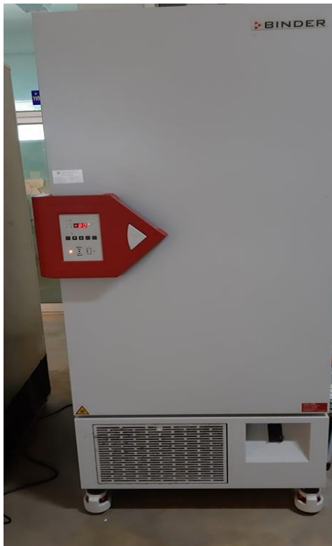
ภาพที่ 10 ตู้แช่แข็งอุณหภูมิต่ำ (-80 °C)
