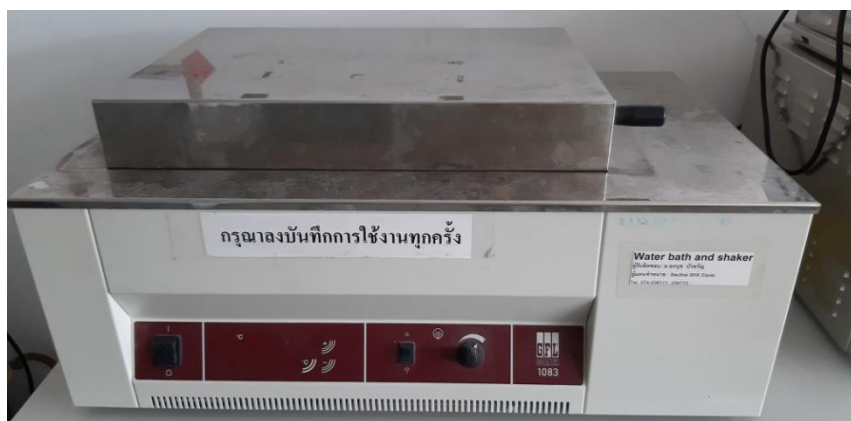
ภาพที่ 8 อ่างน้ำควบคุมอุณหภูมิ
