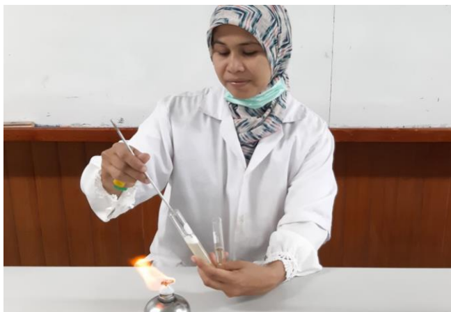
ภาพที่ 38 การเชื่อมต่อแบบหลอดต่อหลอด
